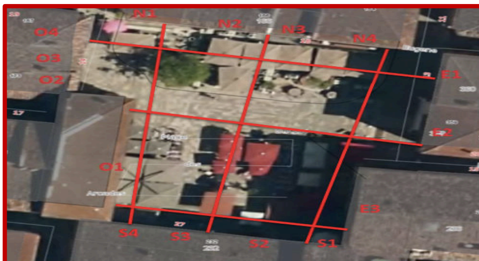
- Position des câblages nécessaires aux illuminations de Noël - - Installation de 12 points d'ancrages -
